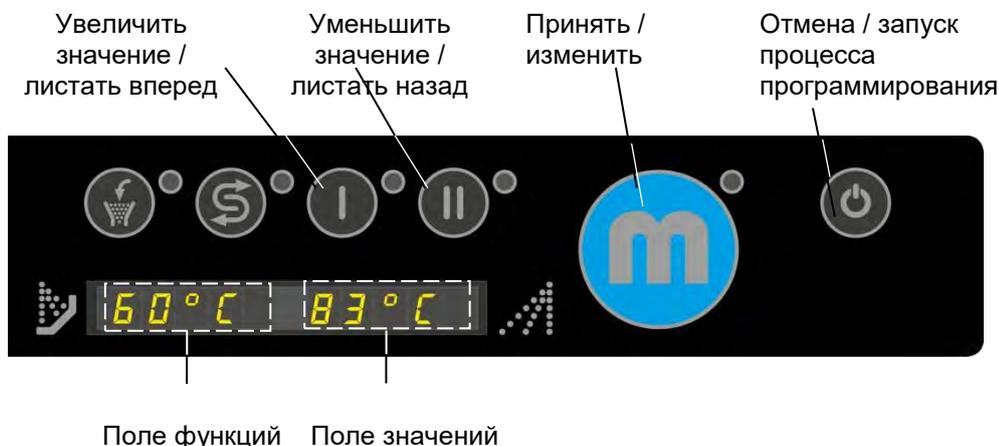
Разным пользовательским уровням соответствуют различные коды доступа. После окончания ввода заданный код сопоставляется с данными встроенной таблицы кодов. В зависимости от введенного кода выполняется переход к соответствующему пользовательскому уровню.
