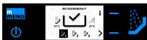
Мытьевой насос и транспортер выключаются. При этом нагревательный элемент бака остается активным и машина остается готовой к работе, о чем свидетельствует надпись на дисплее.
