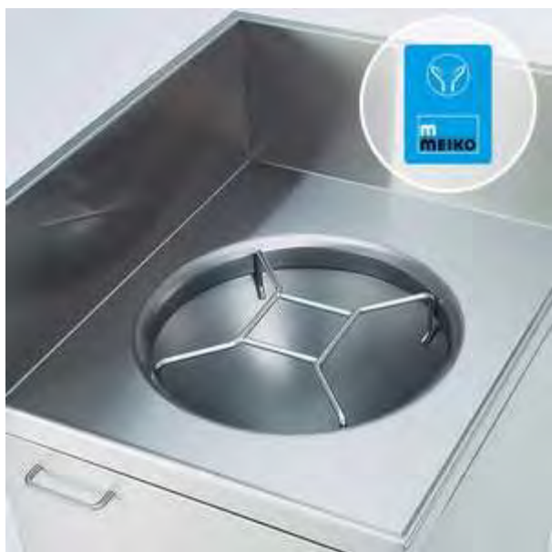
Защитный экран для мойки с промывкой по краю. Сзади и/или сбоку. Промывка по краю (опционально) с помощью очистителя и дезинфицирующего устройства или отдельного источника. Запуск промывки по краям раковины при помощи специальной пленочной клавиатуры (отдельное питание) или с помощью системы управления прибором
